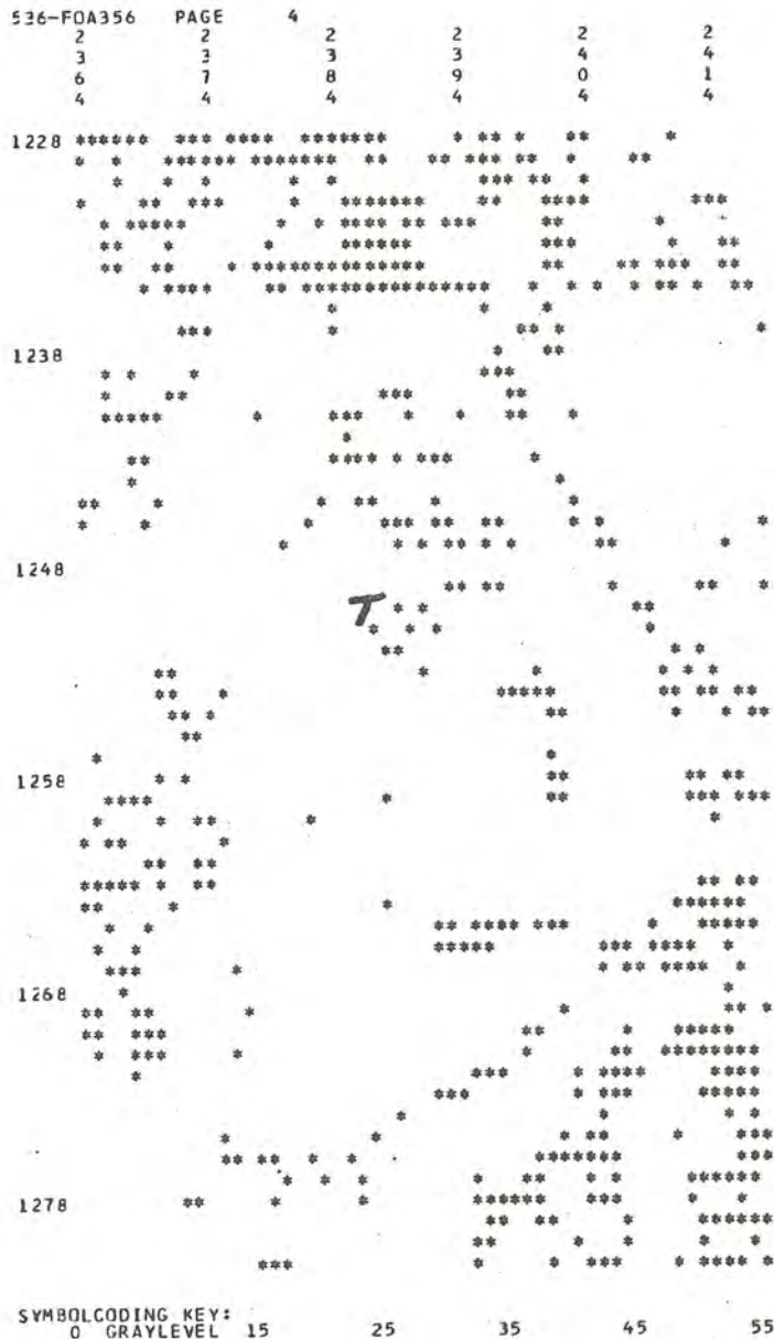
Figur 5.3 Radskrivarbild över närområdet kring isbrytaren TOR (T). Såväl öppet vatten, nyis och snötäckt is är vitt och enbart nivåerna däremellan presenteras i bilden.
