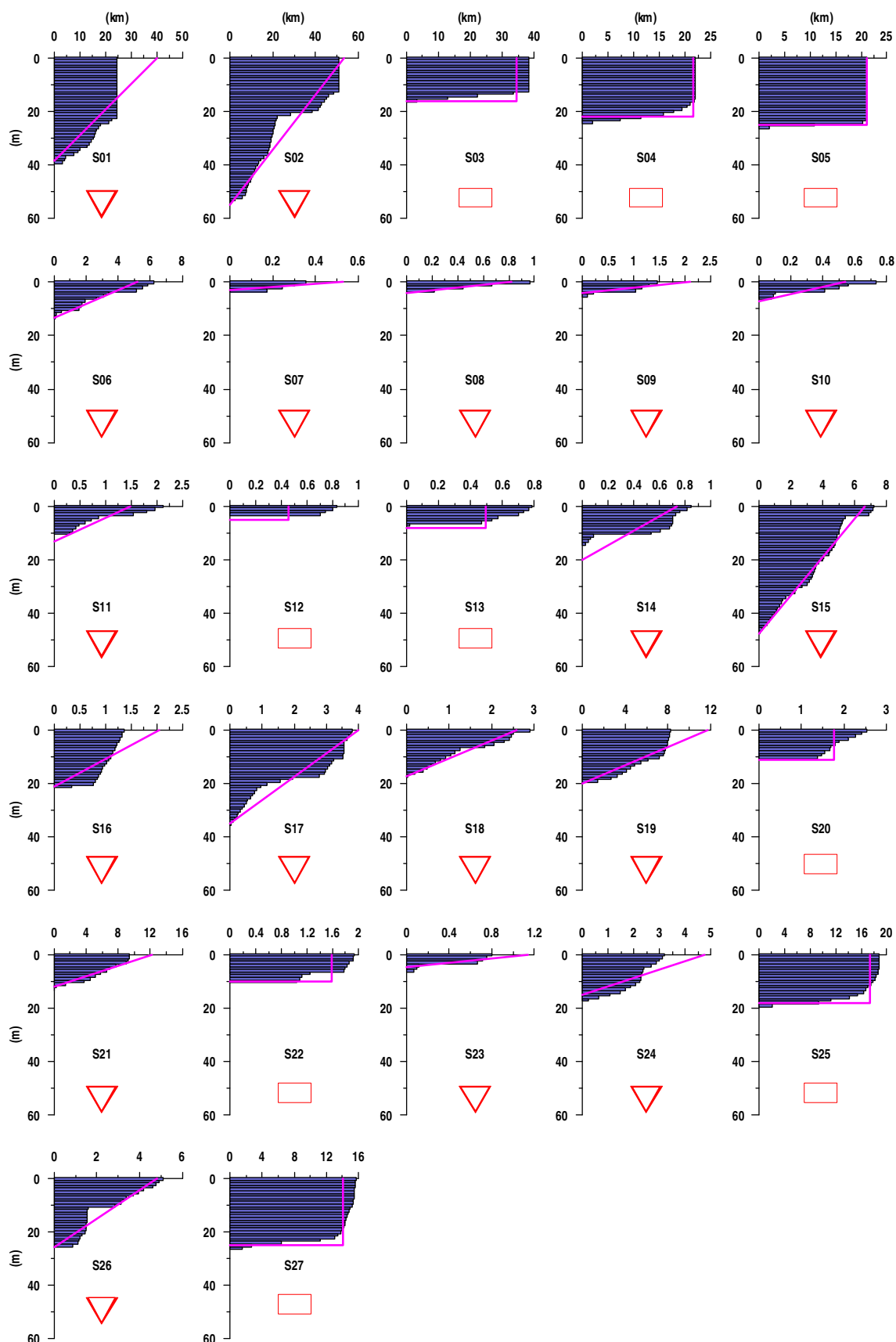
Figur 15. Schematisk bild över tvärsnittsytan för respektive sund framtaget från digitala sjökort (blå staplar), de röda symbolerna anger huruvida vi i modellen betraktar dem som triangulära eller rektangulära, magentafärgad kurva anger modellens tvärsnittsyta.
