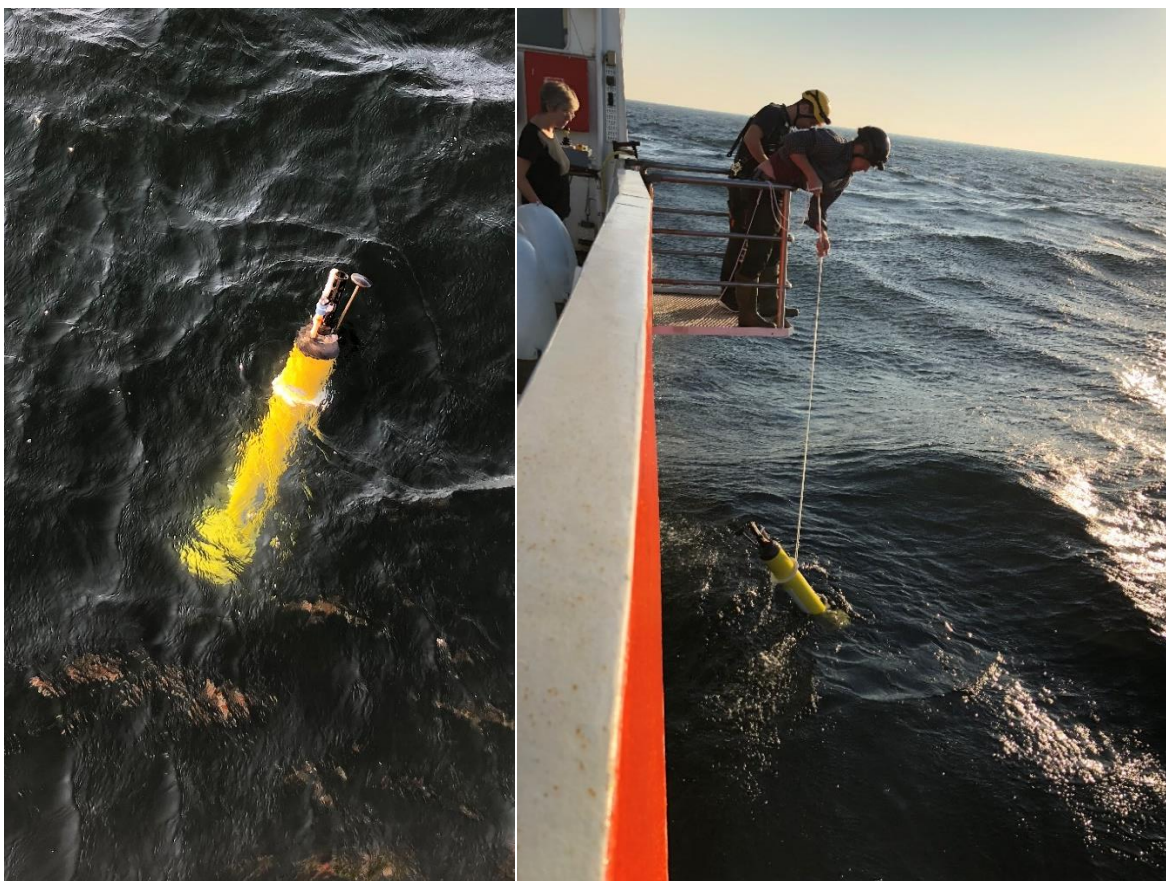
Bild 5. SMHI assisterar finska FMI med upptag och utsättning av Argo floats i Östra Gotlandsbassängen.
